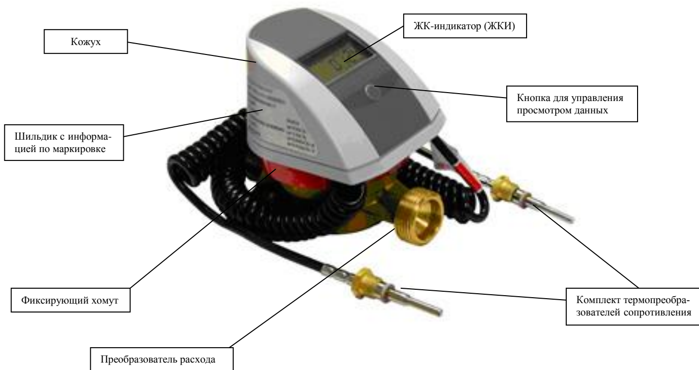
Рисунок 2. Внешний вид и состав теплосчётчика ELF-M
